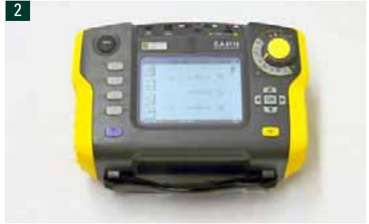
Chauvin Arnoux 6116 von Chauvin Arnoux, mit grossem Display und grafischen Darstellungen der Messschaltungen.
